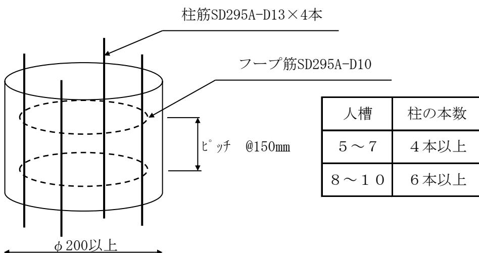
\* 設置される浄化槽の平面積が、従来の浄化槽の平面積より大きい（又は小さい）場合、その面積に応じ、支柱の本数を設定すること。
