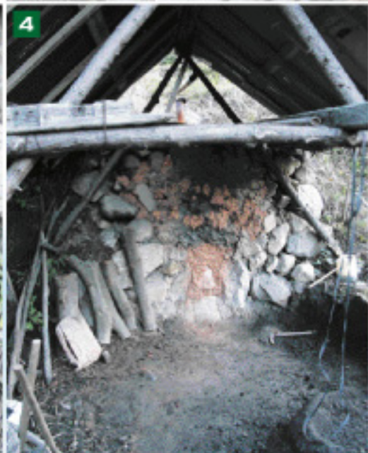
3 炭にする樫の木 4 炭焼き窯。炭にする樫の木は窯の中に立てて入れます。窯が冷えている場合は、炭が出来上がるまでに2、3日かかるそうです。 5 空気が漏れているところは赤土を練ってふさぎます。
