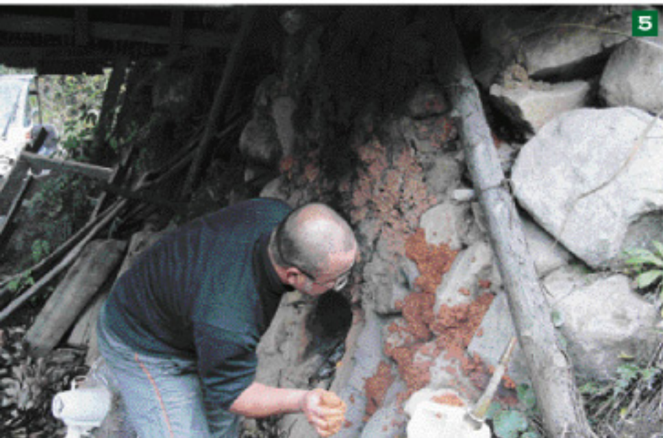
3 炭にする樫の木 4 炭焼き窯。炭にする樫の木は窯の中に立てて入れます。窯が冷えている場合は、炭が出来上がるまでに2、3日かかるそうです。 5 空気が漏れているところは赤土を練ってふさぎます。
